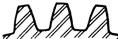
Paso Diametral 5 Paso Circular de .6283"
