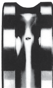
Fig. 5.1 Escamamento na Pista
