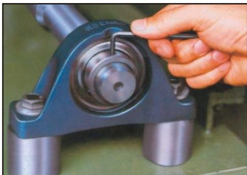
C- Fixar dois parafusos igualmente no eixo. Em condições normais, apertar o parafuso com chave sextavada tipo ALLEN. Em condições mais rigorosas, usinar alojamento do parafuso no eixo para obter melhor fixação. Os valores do torque são dados na tabela ao lado.
