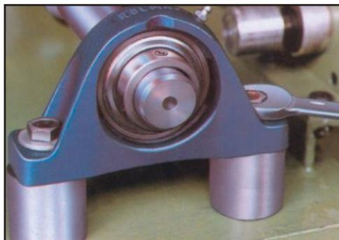
B- Fixar o mancal na base antes de fixar os parafusos de fixação do eixo, verificando a distância entre os mancais e a folga axial dos rolamentos.
