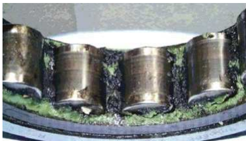
Degradação de lubrificante causado pelas correntes de descarga elétrica
